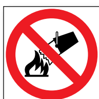
Ref. 410 Prohibido apagar con agua
