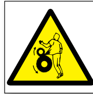
Ref. 377 Peligro Riesgo de atrapamiento
