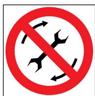
Ref. 482 Prohibido reparar la máquina en funcionamiento
