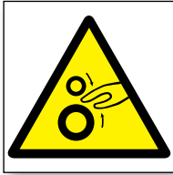
Ref. 358 Peligro Riesgo de atrapamiento
