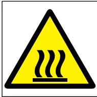
Ref. 379 Peligro Contacto térmico
